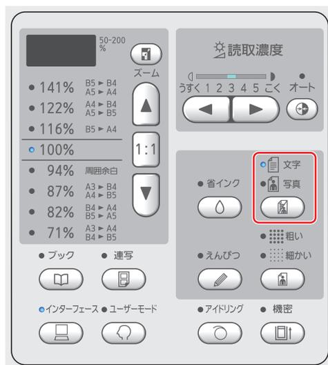
【原稿モード】キーを押すたびに、設定が変更されます。
